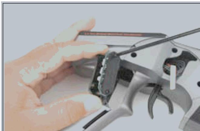
6 – Retirez soigneusement la plaque comportant les boutons D, E et F. Déposez au moyen du tournevis Philips le circuit imprimé et la plaque arrière de la poignée. Notez bien la position des 3 boutons.
