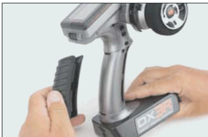
14 – Remettez le grip en place ainsi que les piles. Vous remarquerez que maintenant les boutons D et E fonctionnent à l'envers. Il sera nécessaire de changer le sens de ces interrupteurs dans le menu système (voir page 36).
