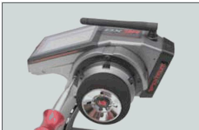
13 – Remontez la bonne plaque arrière et resserrez l'assemblage du volant par ses 3 vis
