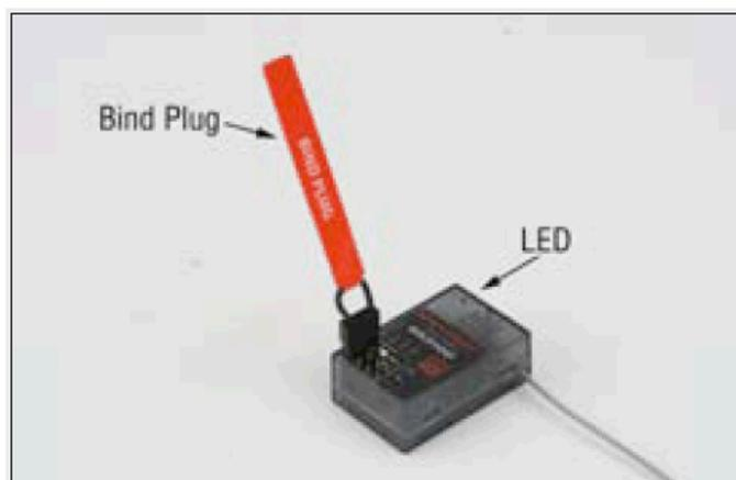
Note : Le récepteur SR3100 équipé de la technologie DSM2 seconde génération est uniquement compatible avec les émetteurs utilisant le protocole DSM2 (comme le DX3R). Les émetteurs DSM1 ne fonctionneront pas avec le SR3100.
