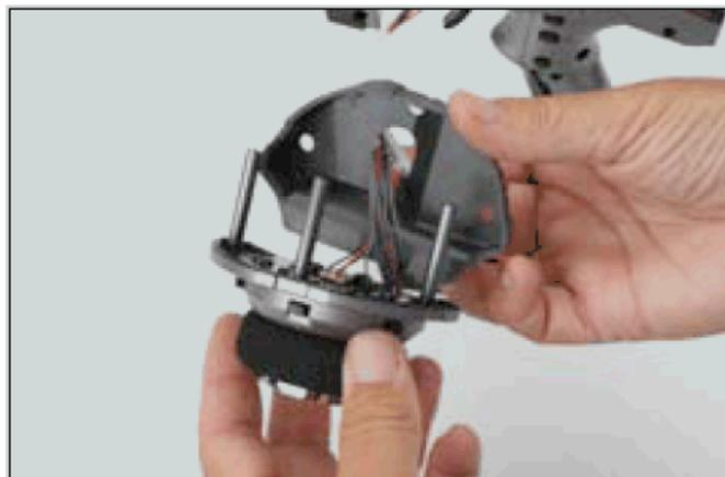
11 – Prenez l'autre couvercle de direction et assemblez-le avec le volant.
