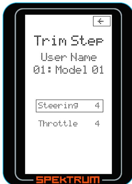
La fonction pas de trim (Trim Step) permet à l'utilisateur d'ajuster la sensibilité des trims de direction et gaz/frein.
