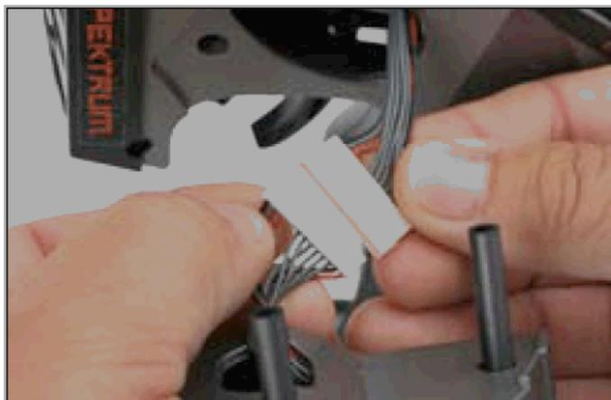
12 – Connectez le mécanisme de volant et assurez vous que les connecteurs soient bien emboîtés. Prêtez bien attention à la polarité.
