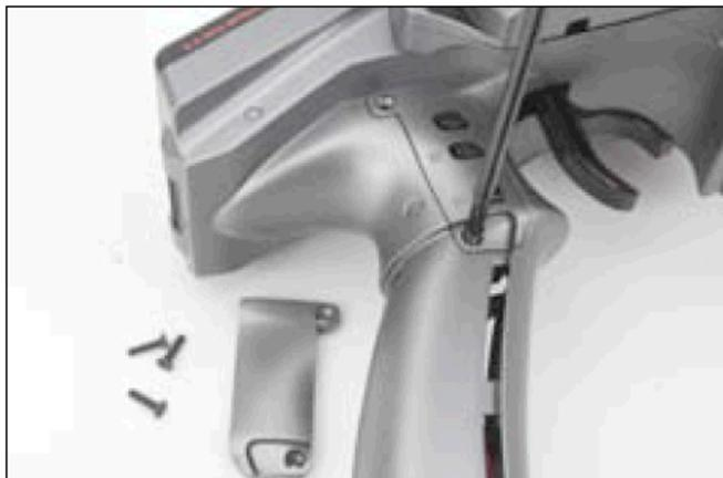
5 – Au moyen du petit tournevis Philips, retirez les 4 vis (2 par coté) qui maintiennent la poignée en place et retirez la plaque sur laquelle il n’y a pas de boutons.
